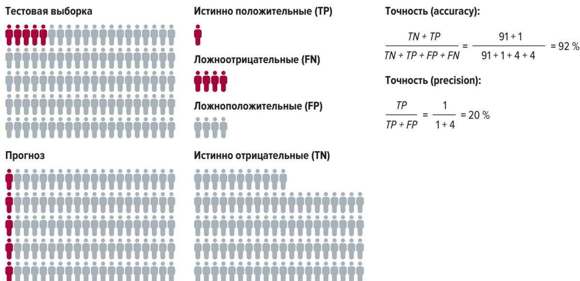
Рис. 4. Определение точности модели машинного обучения (цит. по [2])
